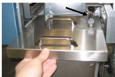
Figura 4: Coloque a tampa na bandeja e deslize o tubo de coleta de óleo para dentro do soquete fêmea de sucção.
